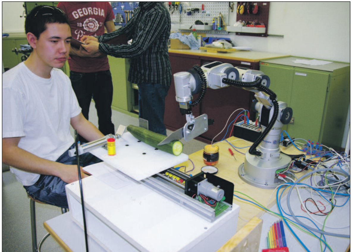
Perfekter, automatischer Schnitt von Gurkenscheiben mit Hilfe des Roboters.
